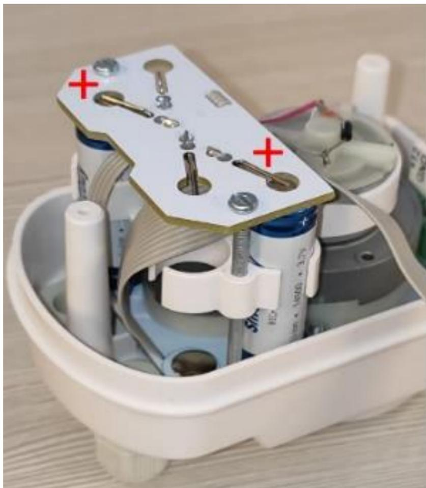
Рисунок 5. Установка аккумуляторов в модель Winner Wi-Fi.
