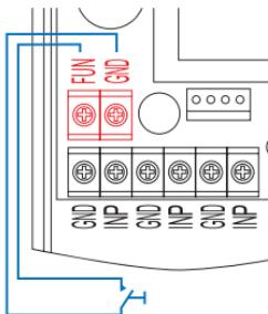
Для дистанционного управления водоснабжением Вам достаточно подключить клеммы FUN, GND блока управления к стандартному выключателю с фиксацией положения.
