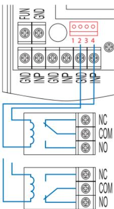
Для подключения к внешней сигнализации используйте специальный разъем на плате блока управления.
