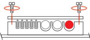
Место ввода кабеля управления электрическим насосом.
