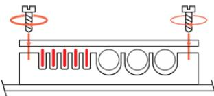
Место ввода кабелей датчиков протечки воды.
