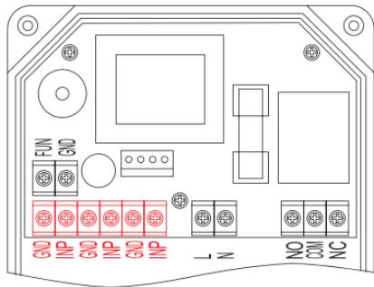
Клеммы для подключения датчиков протечки воды:
