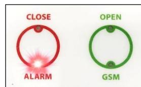
Красный светодиод **ALARM** индицирует аварийные режимы электропривода. Светодиод постоянно светится (питание от внешнего источника 12 вольт) или моргает (питание от батареек) в следующих аварийных ситуациях:
