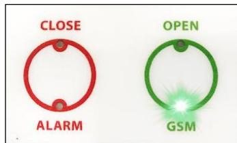
**Зеленый светодиод **GSM** индицирует состояние модуля **GSM**. Светится – питание на модуль **GSM** подано, модуль в режиме ожидания.**
