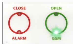
Зеленый светодиод **GSM** индицирует состояние модуля **GSM**.
